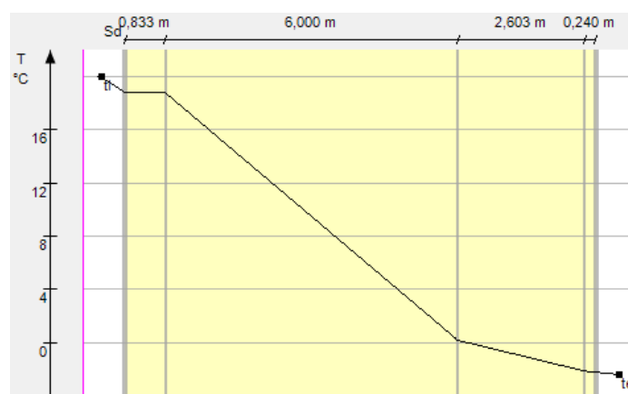
Rys. 47. Rozkład temperatur w przegrodzie projektowanej w lutym.
